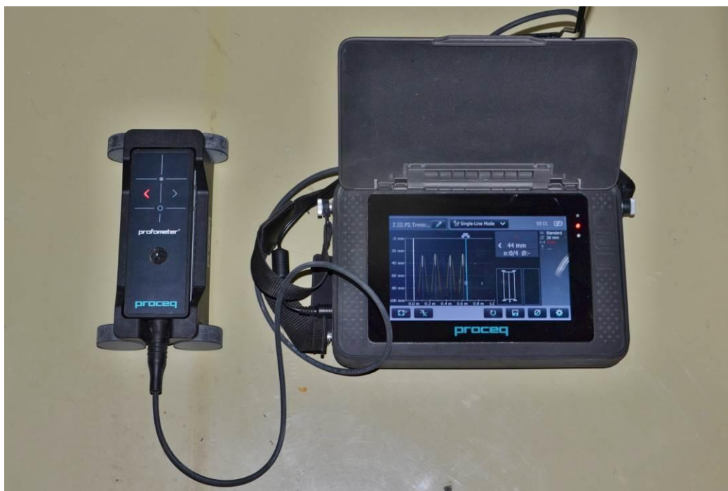
Obrázek 3: Profometer PM-6 s dotykovým displejem a integrovanou sondou; svítící šipky pomáhají lokalizovat výztuž, na displeji lze ihned kontrolovat správnost měření pomocí křivek intenzity signálu.
