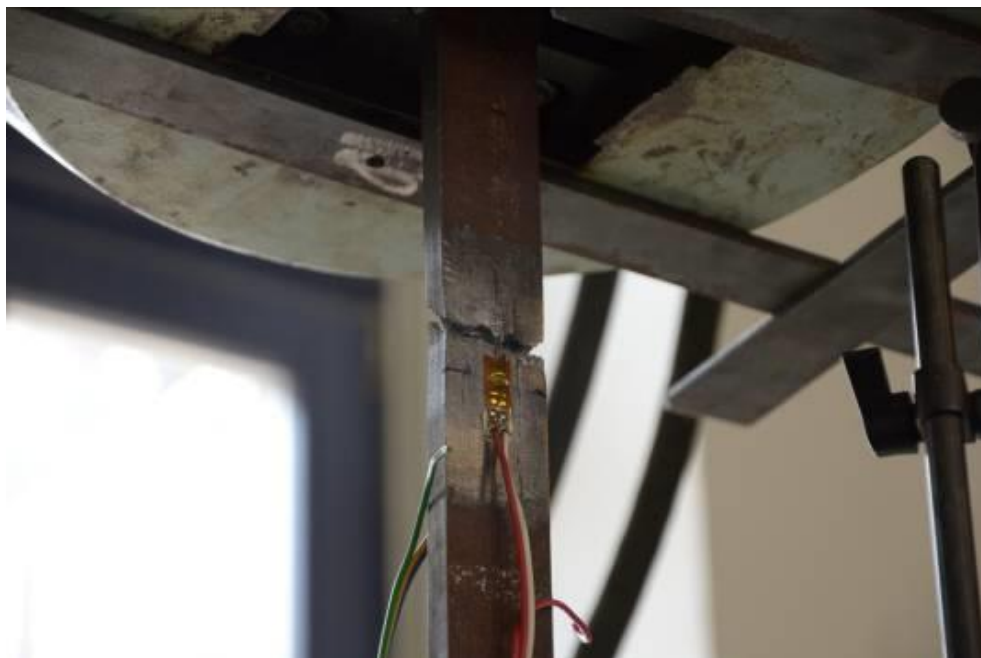
Obrázek 6: Destruktivní zkouška pevnosti v tahu v lisu laboratoře VUT v Brně, FAST. Vzorek po zkoušce.
