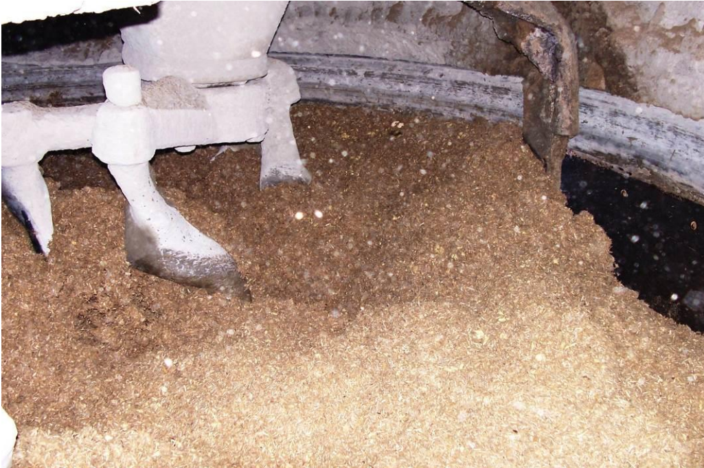
Obrázek 2.: Mísení směsi pro výrobu cementotřískové desky
