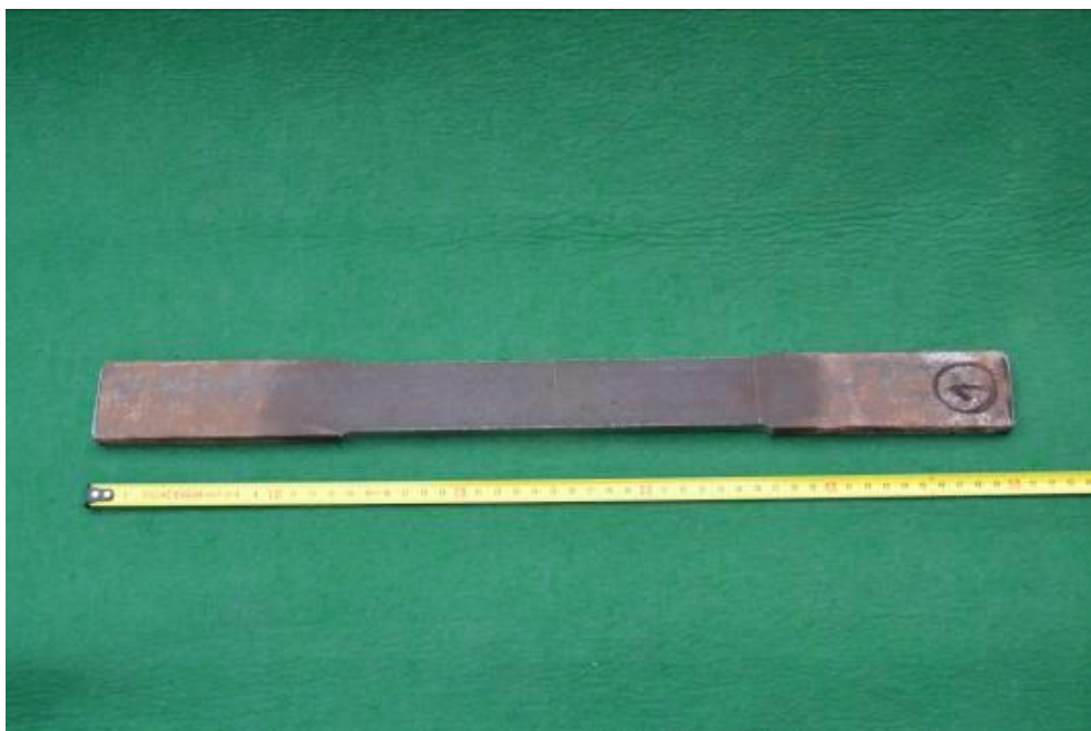
Obrázek 5: Obrobené zkušební těleso dle normy ČSN EN ISO 6892-1 [5].
