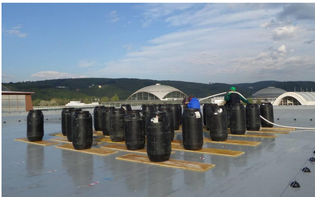
Obrázek 4: Zatěžovací stand - rozmístění sudů a jejich plnění
