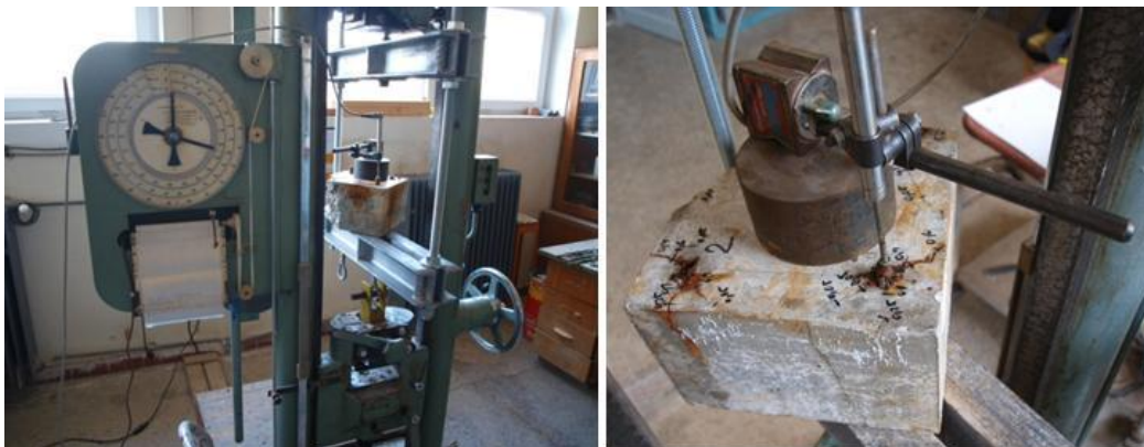
Obrázok 5.: Pull-out test: pohľad na lis a detail umiestnenia vzorky v lise
