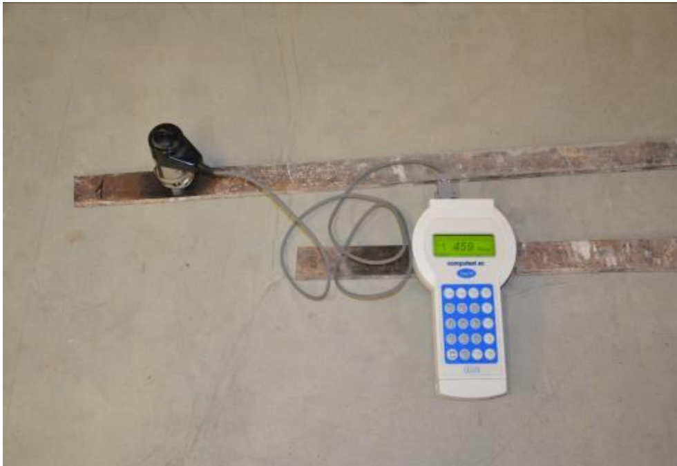
Obrázek 3: Nedestruktivní určení pevnosti kleští pomocí ručního tvrdoměru firmy Computest.
