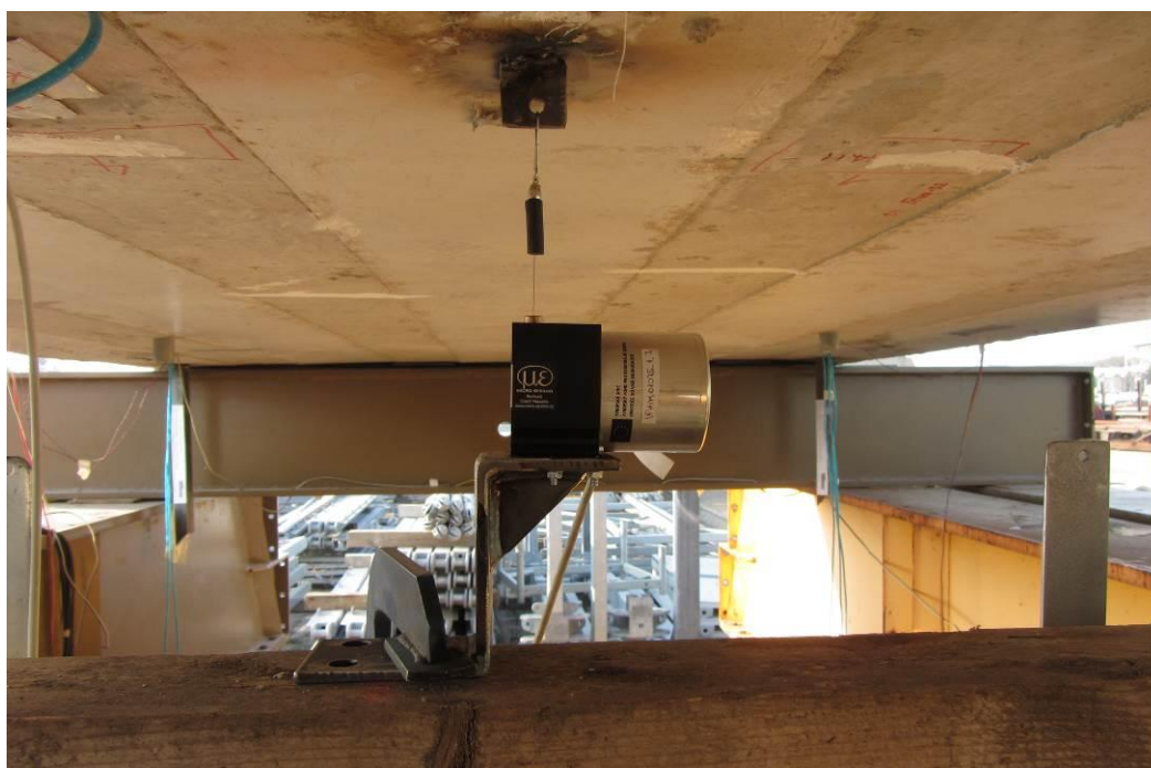
Obrázek 6 – Měření průhybu potenciometrickým snímačem
