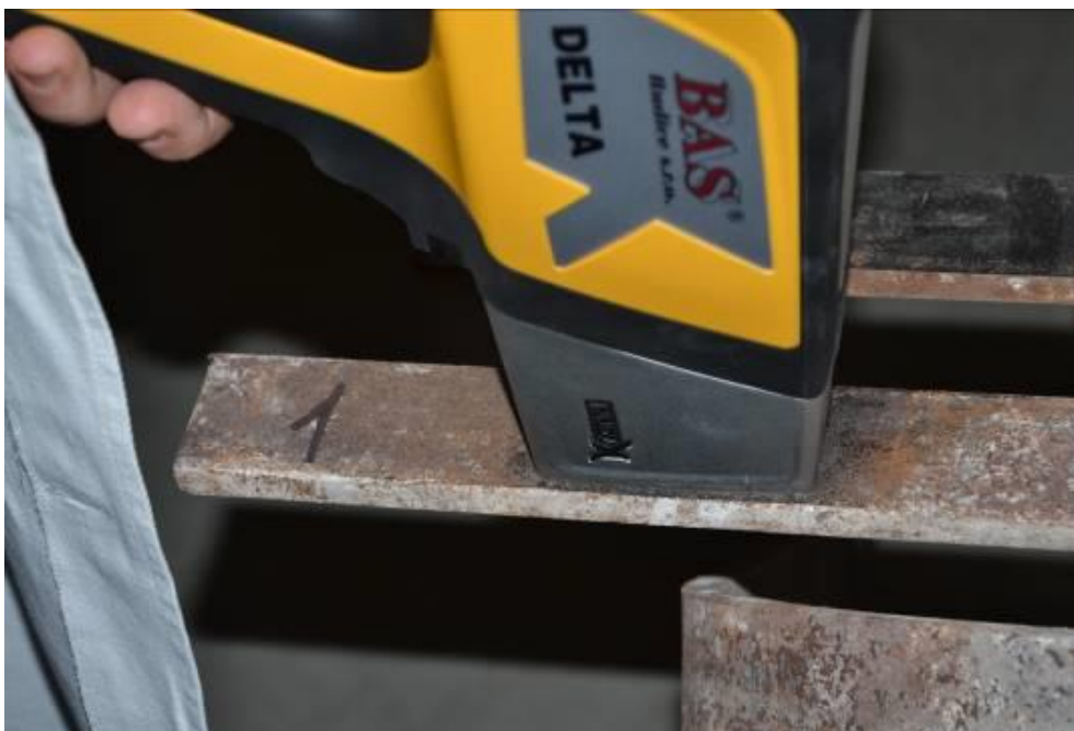
Obrázek 4: Nedestruktivní určení složení pomocí ručního rentgenového analyzátoru firmy Bas Rudice s.r.o.
