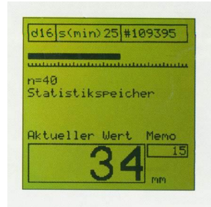
Obrázek 2: Profometer 4 - indikace výchytky a krytí.
