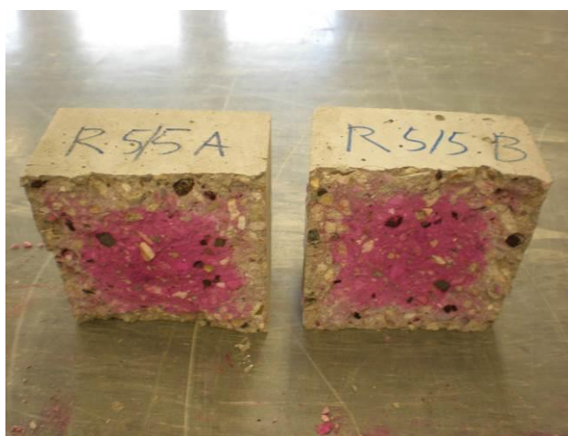
Obrázek 4.: Postup karbonatace na zlomcích krychle betonu z bet. recyklátu + 10 % mikrosiliky
